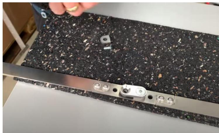
2. **Montagewinkel oder -platten an die Ständer schrauben.** Dazu zunächst die Abstandshalter und die Haltelasche Winkel/Montageplatte an einer Seite montieren, dann an der geeigneten Stelle in den Ständer einfädeln und die zweite Seite montieren. **Senkkopfschrauben M8x16.**
