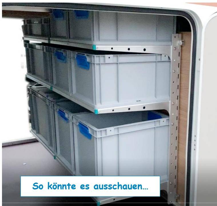
**TIPP: Es hat sich bewährt das Regal komplett vorzumontieren und als fertiges Gerüst dann im Fahrzeug zu verschrauben.**
