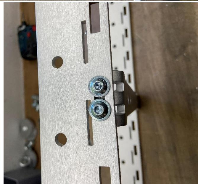
Falls eine Regal-**Erweiterung** verbaut wird, können zwei Montagearten gewählt werden. Entweder wird die Wandleiste der Erweiterung in der Höhe versetzt montiert mit den **Linsenflanschschrauben M6 x 10** – dann ist die Montage wie oben beschrieben.
