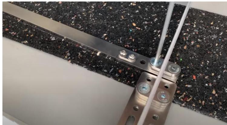
2. **Hauptrahmen in den Stauraum montieren.** Dies erfolgt individuell gemäß der jeweiligen Einbausituation. Wir bieten hierzu im **Shop unter youRS Zubehör** viele verschiedene Winkel, Platten, Schrauben und Fittinge für u.a. Airlineschienen usw. an. Falls ihr mal was nicht finden könnt oder eine spezielle Anforderung habt, bitte einfach melden.
