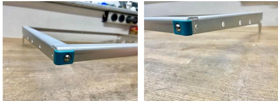
6. **Clipmuttern in die Regalständer an gewünschte Auslegerposition einsetzen, aber noch nicht festziehen.** Bei Basismodulen bzw. wenn nur ein Ausleger an einen Ständer eingehängt werden soll, wird die Clipmutter mit Hilfe einer **Linsenflanschschraube M6x8 festgeschraubt.**
