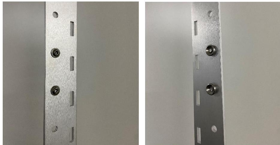
**Bei Erweiterungsmodulen**, wo zwei Boxenrahmen auf selber Ebene eingehängt werden sollen, müssen beidseitig Clipmuttern verschraubt werden. Dazu die **Kreuzschlitz Senkkopfschraube M6x8** in eine Clipmutter eindrehen, durch das Montageloch im Ständer fädeln und auf der anderen Seite die zweite Clipmutter **locker** aufschrauben und **ebenfalls noch nicht festziehen**.
