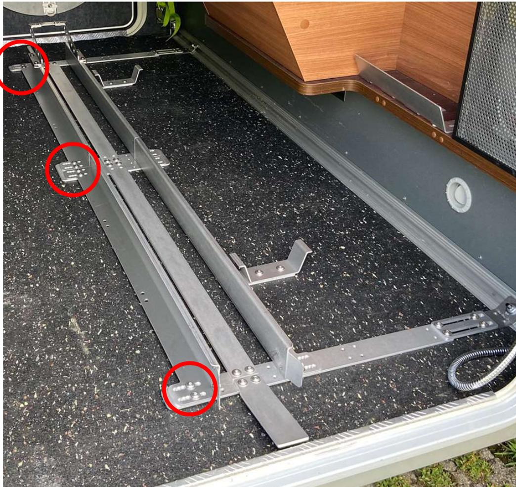
3. **Laschen montieren.** Am vorderen Ende der Bodengruppe sind zwei Einfädel-Laschen vorgesehen, die den Übergang von der Auffahrschiene zur Bodengruppe erleichtern sollen. Es wird je Seite eine Lasche mit je zwei Stück **M4x4 Linsenschrauben** montiert.
